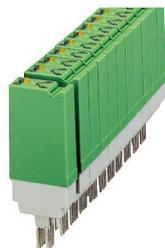
Relé de estado sólido de potência encaixável, com indicador luminoso e ligação de proteção no circuito de entrada e saída, entrada: 12 V AC, saída: 12-60 V DC/máx. 1A, encaixável em blocos de terminais de base
