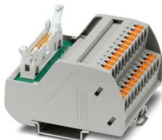
Módulo VARIOFACE, com conexão push-in e conector de encaixe de cabo de fita plana, para montagem sobre trilhos de fixação NS 35, com régua de pinos, bem como arcos de travamento curtos e longos para régua de soquetes, número de polos: 20, com LED
