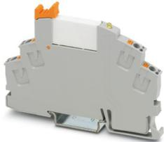
Módulo de relé pré-montado com conexão push-in, composto por: base de relé com ejetor e relé de contato de potência. Versão de contato: 1 contato normalmente aberto. Tensão de entrada: 24 V DC
