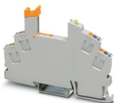
Base de relé RIF-0..., para relé miniatura de potência com 1 contato normalmente aberto ou relé de estado sólido com o mesmo formato, conexão push-in, para montagem no NS 35/7,5
