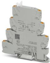
PLC-INTERFACE para aplicações ferroviárias, composta por terminal básico com conexão push-in e relé de estado sólido miniatura integrado, faixa:  $0,7 \times U_N$  a  $1,25 \times U_N$ , faixa de temperatura:  $-25\text{ °C}$  a  $+70\text{ °C}$ , 1 contato normalmente aberto, entrada: 96 V DC, saída: 12-140 V DC/3 A
