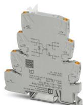
PLC-INTERFACE para aplicações ferroviárias, composta por terminal básico com conexão push-in e relé de estado sólido miniatura integrado, faixa:  $0,7 \times U_N$  a  $1,25 \times U_N$ , faixa de temperatura:  $-25 \text{ °C}$  a  $+70 \text{ °C}$ , 1 contato normalmente aberto, entrada: 24 V DC, saída: 3-33 V DC/3 A
