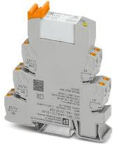
PLC-INTERFACE, composta por terminal básico PLC-BPT.../21-21 com conexão push-in e relé miniatura plugável com contato folheado a ouro de várias camadas, para montagem em trilho de fixação NS 35/7,5, 2 contatos reversíveis, tensão de entrada 24 V AC/DC
