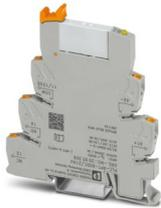
PLC-INTERFACE, composta por terminal básico PLC-BPT.../21 com conexão push-in e relé miniatura plugável com contato folheado a ouro de várias camadas, para montagem em trilho de fixação NS 35/7,5, 1 contato reversível, tensão de entrada 60 V DC
