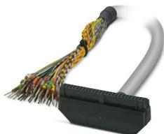
Cabo circular montado; conexão 1: Condutores individuais (50-polos) (Os condutores estão identificados e equipados com terminais tubulares); conexão 2: Régua de soquetes IDC/FLK (1x 50-polos, 90 °-saída); comprimento de cabo: 1 m
