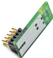
A HOPKEY contém informações como, p. ex., as frequências de transmissão utilizadas e a sequência de salto. Estas informações são necessárias, por ex., para o receptor/repetidor adicional poder ser integrado a um sistema existente.
