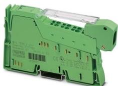
Inline, Terminal de sensor de temperatura, Entradas UTH analógicas: 2 (Termopares ou tensão linear), tecnologia de conexão: 2 condutores, velocidade de transmissão no bus local: 500 kBit/s, grau de proteção: IP20, inclusive conector Inline e campo de identificação
