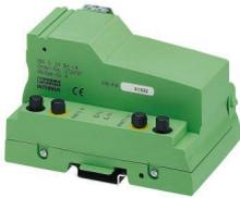
Inline, Acoplador Bus, INTERBUS, Conector F-SMA, velocidade de transmissão no bus local: 2 MBit/s, grau de proteção: IP20, sem acessórios
