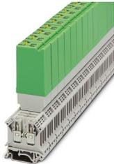
Módulo de relé para altas correntes de comutação, contatos (AgCdO+avanço de tungstênio): potências médias a grandes, 1 elemento de contato, tensão de entrada 24 V DC, máx. corrente de comutação 10 A
