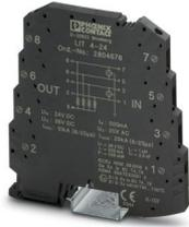
Proteção contra surtos no módulo para fixação em trilho com 6,2 mm de largura para quatro condutores de sinal flutuantes. Testado de acordo com o tipo de proteção contra ignição nas áreas Ex: Ex ia IIC / Ex iaD.
