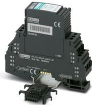
Proteção contra surto composta por plugue de proteção e elemento de base, com indicação de estado integrada em vários níveis no módulo para quatro condutores de sinal com potencial de referência comum. Aterramento indireto através de centelhador a gás. Pode ser usado em circuitos relacionados à segurança até SIL 3.
