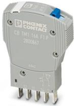
Disjuntor de proteção de equipamento termomagnético, 1 polo, curva característica de disparo F1 (flink), 1 contato inversor, conector para elemento de base.
