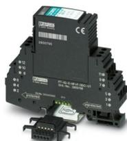
Proteção contra surto, composta por plugue de proteção e elemento de base, com indicação de estado de vários níveis integrada no módulo para cinco condutores de sinal. Para aplicações de alta frequência e interfaces de telecomunicação sem tensão de alimentação (de até 90 MBit/s). Pode ser usado em circuitos relacionados à segurança até SIL 3.
