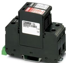
Protetor contra descargas atmosféricas/surtos de tensão universal plugável à base de varistor para redes de fornecimento de energia monofásicas com N e PE separados (sistema de 3 condutores: L1, N, PE), com contato de sinalização remota.
