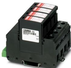
Dispositivo de proteção contra raios plugável à base de varistor para redes trifásicas TN-S com N e PE separados (rede de 5 condutores: L1, L2, L3, N, PE), para as classes de proteção contra raios III e IV, com contato de sinalização remoto.
