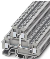
Borne miniatura de passagem, com conector de potencial, tensão nominal: 500 V, corrente nominal: 24 A, tipo de conexão: Conexão a parafuso, 1. e 2o. nível, Bitola: 2,5 mm<sup>2</sup>, perfil de conexão: 0,2 mm<sup>2</sup> - 4 mm<sup>2</sup>, tipo de montagem: NS 15, NS 35/7,5, NS 35/15, cor: cinza
