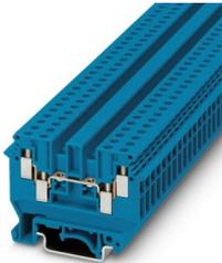
Borne de passagem, tensão nominal: 630 V, corrente nominal: 32 A, quantidade de conexões: 4, número de polos: 1, tipo de conexão: Conexão a parafuso, Bitola: 4 mm<sup>2</sup>, 1. nível, perfil de conexão: 0,2 mm<sup>2</sup> - 6 mm<sup>2</sup>, tipo de montagem: NS 35/7,5, NS 35/15, NS 32, cor: azul
