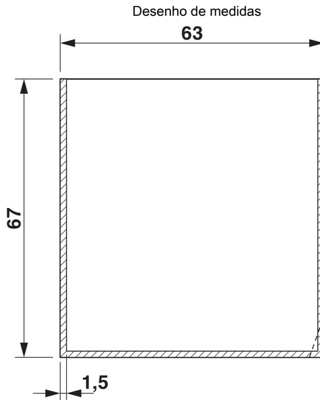
válido para placa de circuito impresso 1; 2; 3; 4; 5 e 6, vide desenho expandido
