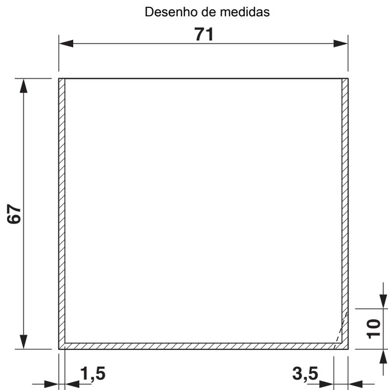
válido para placa de circuito impresso 9, vide desenho expandido
