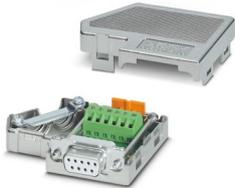
Conector D-SUB, soquete de 9 polos, entrada de cabos de 35° sobre uma régua de terminais, sistema de bus: CAN, CANopen®, SafetyBus-P até 1 MBit/s, resistor de terminação comutável via chave deslizante, atribuição de pinos: 2, 3, 7; bornes de conexão a parafuso
