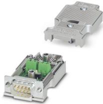
Conector D-SUB, 9 pólos, pino, versão axial, com duas saídas de cabo, sistema Bus: PROFIBUS DP até 12 MBit/s, resistor de terminação comutável externamente, configuração de pinos: 3, 5, 6, 8; tecnologia de conexão a parafuso
