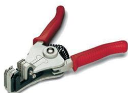
Alicate de isolamento para rebaixar os elementos individuais do cabo de fibra óptica. Especialmente adequado para todos os cabos de polímeros e PCF. Mecânica especial e formas de lâmina precisas evitam danos na fibra óptica. Dimensões: (CxLxA) 160x130x36 mm
