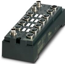
O módulo local Bus tem entradas e saídas digitais. Funções: 4 entradas digitais com tempo de filtro de 3 ms, 4 saídas digitais de 2 A cada, 500 KBd / 2 MBd comutável, diagnóstico com canal preciso, proteção contra curto-circuito e sobrecarga, tecnologia de conexão rápida M12
