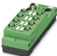
O módulo Stand-Alone para DeviceNet™ tem 16 entradas digitais. A conexão M12 é feita pela tecnologia de conexão rápida. A alimentação 24 V DC é protegida contra curto-circuito e sobrecarga. A corrente nominal do módulo é de 1,2 A.
