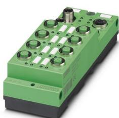
O módulo Stand-Alone para INTERBUS tem 16 entradas digitais. A conexão M12 é feita pela tecnologia de conexão rápida. A alimentação 24 V DC é protegida contra curto-circuito e sobrecarga. A corrente nominal do módulo é 1,2 A.
