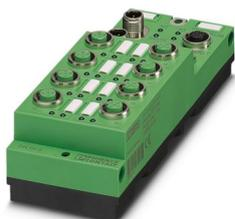
O módulo Stand-Alone para DeviceNet™ tem 8 entradas digitais. A conexão M12 é feita pela tecnologia de conexão rápida. A alimentação 24 V DC é protegida contra curto-circuito e sobrecarga. A corrente nominal do módulo é de 600 mA.
