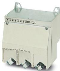
Módulo de entrada/saída digital para INTERBUS; tecnologia de fibra óptica com 2 MBaud, 8 entradas (24 V DC), 8 saídas de relé (12 V AC até 250 V AC, máximo 2 A), conexão de sensores através de conectores M12 de 5 pólos, caixa metálica robusta, grau de proteção IP67
