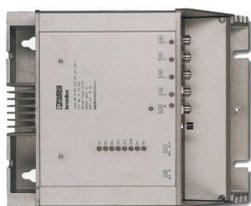
Drive Shuttle, disjuntor de motor INTERBUS para funcionamento com inversão de carga com partida suave, 4 entradas digitais, 24 V DC, grau de proteção IP54
