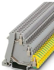
Bornes para sensores/atuadores, tensão nominal: 250 V, corrente nominal: 24 A, tipo de conexão: Conexão a parafuso, Bitola: 2,5 mm<sup>2</sup>, perfil de conexão: 0,2 mm<sup>2</sup> - 4 mm<sup>2</sup>, tipo de montagem: NS 35/7,5, NS 35/15, cor: cinza
