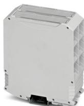
Caixa para trilho de fixação, Caixa completa com travamento metálico da base, formato alto, sem fendas de ventilação, largura: 45,2 mm, altura: 99 mm, profundidade: 113,65 mm, cor: cinza claro (semelhante RAL 7035), conexão transversal: Conector bus para trilho de fixação (opcional), número de polos conector transversal: 5
