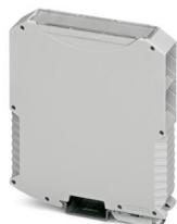
Caixa para trilho de fixação, Caixa completa com travamento metálico da base, formato alto, sem fendas de ventilação, largura: 22,6 mm, altura: 99 mm, profundidade: 113,65 mm, cor: cinza claro (semelhante RAL 7035), conexão transversal: Conector bus para trilho de fixação (opcional), número de polos conector transversal: 5
