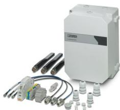
Conjunto de caixa de comando para a construção de sistemas de rádio para aplicações industriais, incl. três antenas omnidirecionais diretamente enroscáveis de 2,4 / 5 GHz, IP66, com trilho de fixação, bujões e conexões roscadas, com fonte de alimentação de 100 V ... 240 V, sem equipamentos
