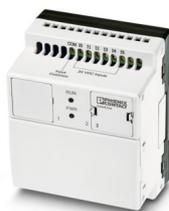
24 Unidade base V CC Nanoline. Equipado com 6 canais de entrada digitais e 4 canais de saída digitais NPN. É possível incluir canais de I/O e utilizar 3 módulos de expansão de I/O, no máximo. Módulos de comunicação opcionais possibilitam conectividade de rede ou serial. Painel de operação opcional com superfície de usuário. Programação por meio de nanoNavigator.
