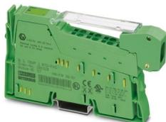
Inline, Terminal de sensor de temperatura, Entradas analógicas RTD: 2, tecnologia de conexão: 2, 3, 4 condutores, velocidade de transmissão no bus local: 500 kBit/s, Variante Extreme Conditions, grau de proteção: IP20, inclusive conector Inline e campo de identificação
