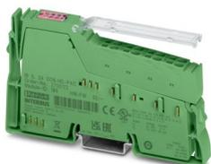
Inline, Terminal de saída digital, Saídas digitais: 8, 24 V DC, tecnologia de conexão: 1 condutor, Variante Extreme Conditions, velocidade de transmissão no bus local: 500 kBit/s, grau de proteção: IP20, inclusive conector Inline e campo de identificação
