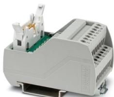
Módulo VARIOFACE, com conexão por rosqueamento e conector de cabo de fita plana, para montagem sobre trilhos de fixação NS 35, com barras de pinos macho, bem como estribos de travamento curtos e longos para barras de pinos fêmea, número de pinos: 14, com LED
