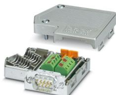
Conector D-SUB, 9 polos, pino, duas entradas de cabos inferiores a 35°, sistema de bus: para acoplador de bus Inline Modbus RTU/ASCII, resistor de terminação comutável externamente, configuração de pinos: 3, 5, 6, 8; terminais de conexão de parafuso
