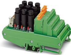
Módulo VARIOFACE, para canais com bornes positivos e negativos adicionais. Cada canal é protegido por um fusível (5 x 20 mm) e dispõe de uma indicação de queda do fusível. A linha de sinal pode ser interrompida por uma lâmina de separação
