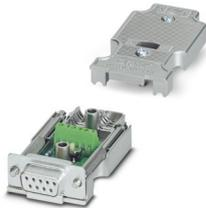
Conector D-SUB, soquete de 9 polos, versão axial com duas entradas de cabos, sistema de bus: CAN, CANopen, SafetyBus-P; configuração de pinos: 2, 3, 7; terminais de conexão por rosqueamento
