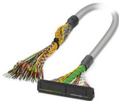
Cabo circular montado; conexão 1: Condutores individuais (50-polos) (Os condutores estão identificados e equipados com terminais tubulares); conexão 2: Régua de soquetes IDC/FLK (1x 50-polos); comprimento de cabo: 8 m
