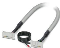
Cabo circular, montado blindado; conexão 1: Régua de soquetes IDC/FLK (1x 16-polos); conexão 2: Régua de soquetes IDC/FLK (1x 16-polos) (Os fios da blindagem saem para uma extremidade em separado do cabo.); comprimento de cabo: 1,5 m
