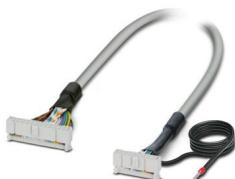
Cabo circular, montado blindado; controle: Emerson Delta V; conexão 1: Régua de soquetes IDC/FLK (1x 24-polos); conexão 2: Régua de soquetes IDC/FLK (1x 16-polos); comprimento de cabo: 1 m
