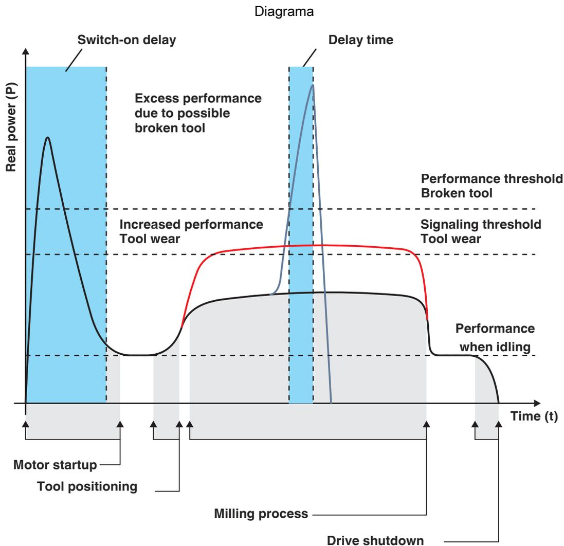
Monitoramento de estado: máquina de ferramenta durante a fresagem
