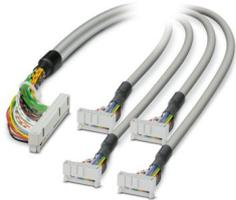
Cabo circular montado; controle: Allen-Bradley SLC 500 (OB 32); conexão 1: Régua de soquetes IDC/FLK (1x 40-polos); conexão 2: Régua de soquetes IDC/FLK (4x 14-polos); comprimento de cabo: 0,5 m
