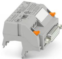
Adaptador V8 para 8 x PLC-INTERFACE (6,2 mm), controle: Cabeamento de sistema PLC de placas de saída, conexão 1: Conector de soquetes D-SUB 1x 15-polos, conexão 2: Conexão de encaixe (Encaixável em 8x bornes PLC-INTERFACE), conexão 3: Conexão a parafuso 1x 2-polos, quantidade de canais: 8, lógica de controle: comutação positiva
