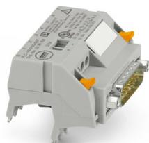
Adaptador V8 para 8 x PLC-INTERFACE (6,2 mm), controle: Cabeamento de sistema PLC de placas de saída, conexão 1: Régua de pinos D-SUB 1x 15-polos, conexão 2: Conexão de encaixe (Encaixável em 8x bornes PLC-INTERFACE), conexão 3: Conexão a parafuso 1x 2-polos, quantidade de canais: 8, lógica de controle: comutação positiva
