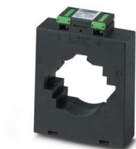
Transformador de corrente plugável, corrente primária 400 A AC; corrente secundária 5 A AC; classe de precisão 1; potência nominal 7,5 VA
