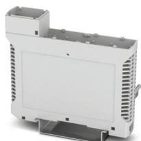
Caixa para trilho de fixação, Parte inferior da caixa com travamento metálico da base, para conector bus 10/10, largura: 39,7 mm, altura: 180,1 mm, profundidade: 137,7 mm, cor: cinza claro (semelhante RAL 7035), conexão transversal: Conector bus para trilho de fixação (opcional), número de polos conector transversal: 10
